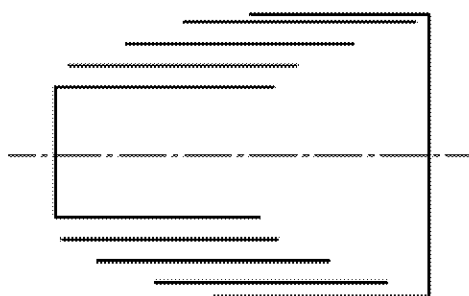
付図 30 竹の子ばね (簡略図)
